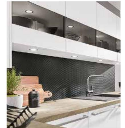
Wandschränke mit integrierter LED-Leuchte NOVA PLUS. Diese kann sowohl im Unterboden als auch im Oberboden eingesetzt werden. Bei Boulevard-Vitrinen ist auch der Einbau im Fachoberboden möglich.
